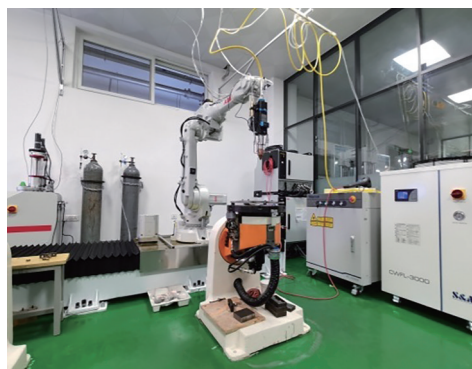
图1 3 kW 光纤熔覆激光机
