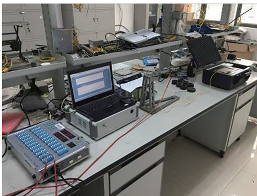
图 1 wFBG 的力敏性能检测实验平台
