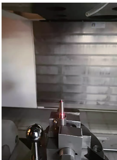
图 10 喷油嘴定位操作
