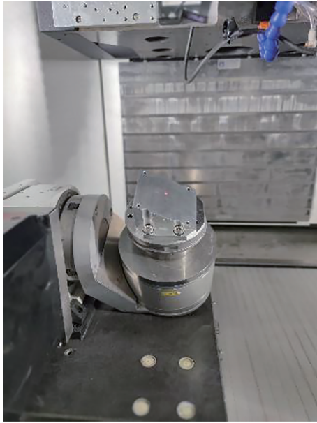
图 8 转轴标定示意图
