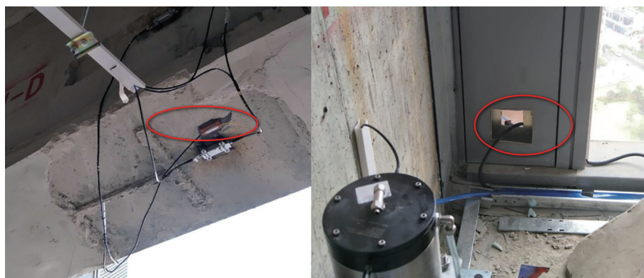
图 5 温度传感器现场安装效果图
