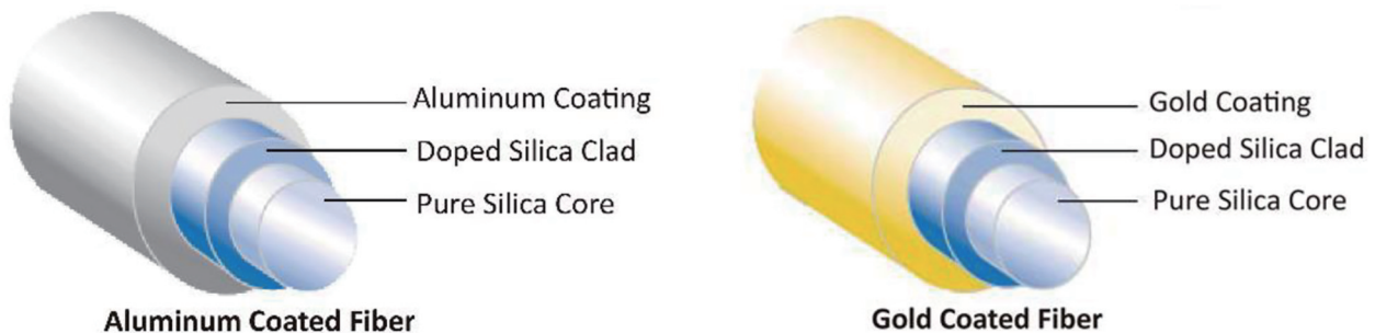
图4 Fiberguide Industries生产的铝涂层、金涂层光纤结构示意图 [57]
