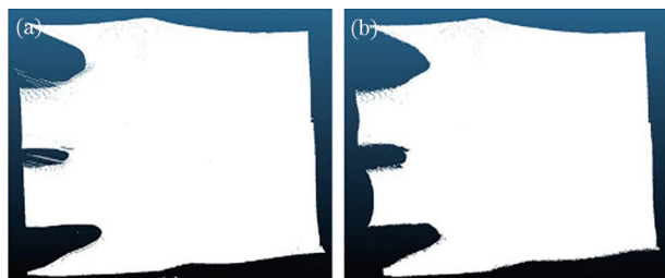
图 17 点云滤波结果。(a)点云滤波前;(b)点云滤波后
