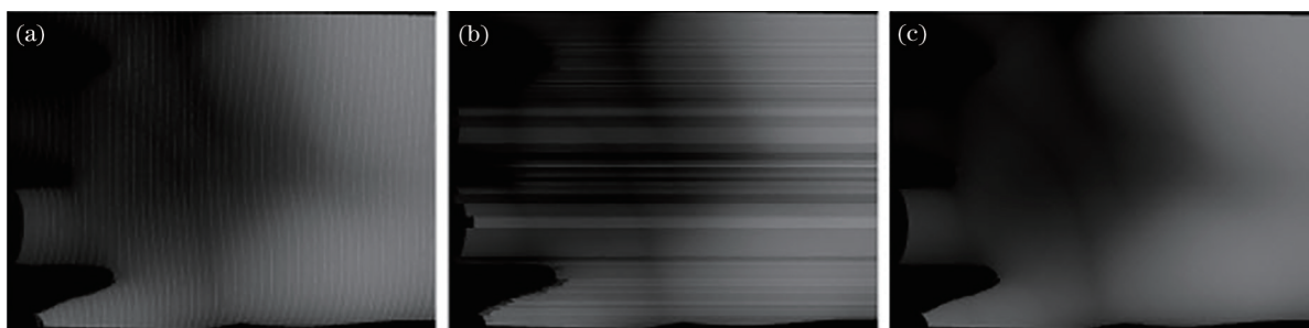
图 5 周期跳变校正的视差图。(a)校正前图像;(b)使用传统方法校正后的图像;(c)使用最大概率法校正后的图像
