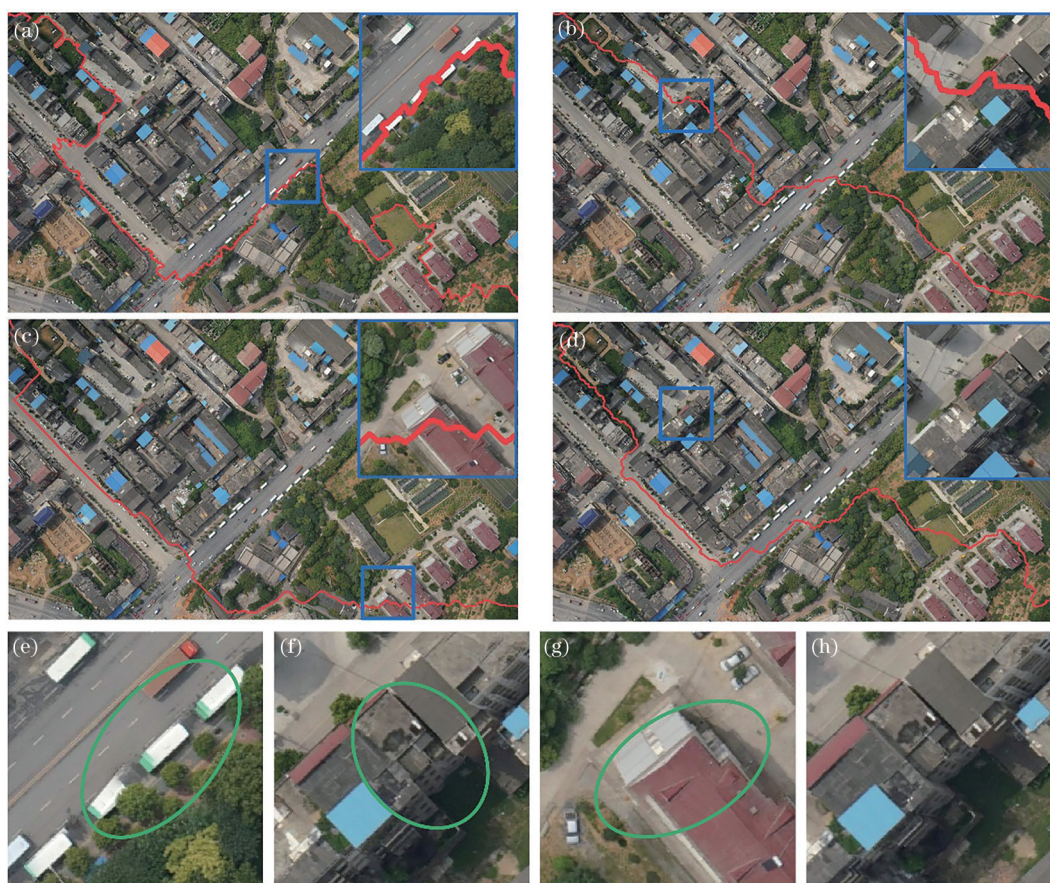
图 8 四种算法缝合线检测及平滑过渡融合结果对比。(a) Chon's 算法缝合线;(b) HVDA 算法缝合线;(c) QESE 算法缝合线;(d) 所提算法缝合线;(e)~(h) 对应方框区域放大
