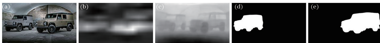
图2 辅助图的输出。(a)原图;(b)焦点图;(c)景深图;(d)左边车辆对应的Mask;(e)右边车辆对应的Mask
