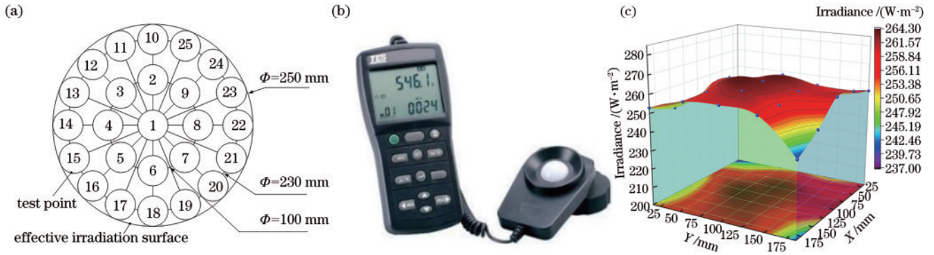
图 14 背景光辐照均匀度的测试。(a)测试方法;(b)测试设备;(c)测试结果
