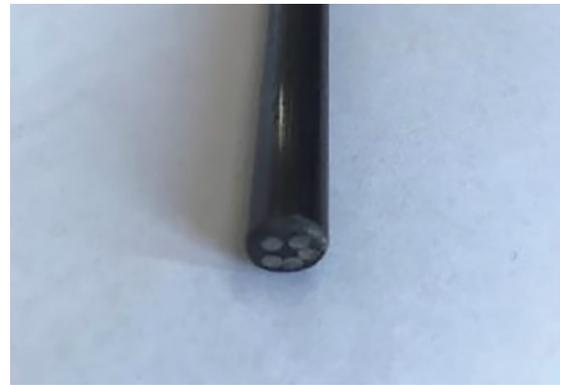
图 1 CFRP 筋材截面
