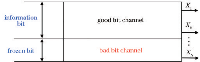
图 4 极化码编码结构
