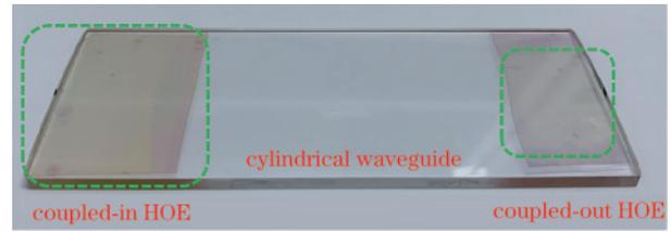
图 5 曝光制备的柱面全息波导
