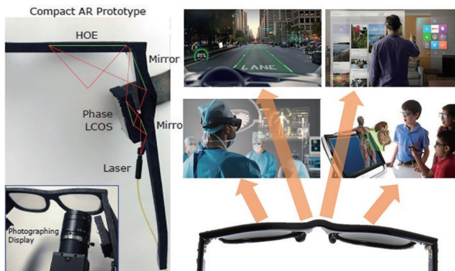
图 13 可穿戴式全息 AR 眼镜原型及潜在应用场景 [60]
