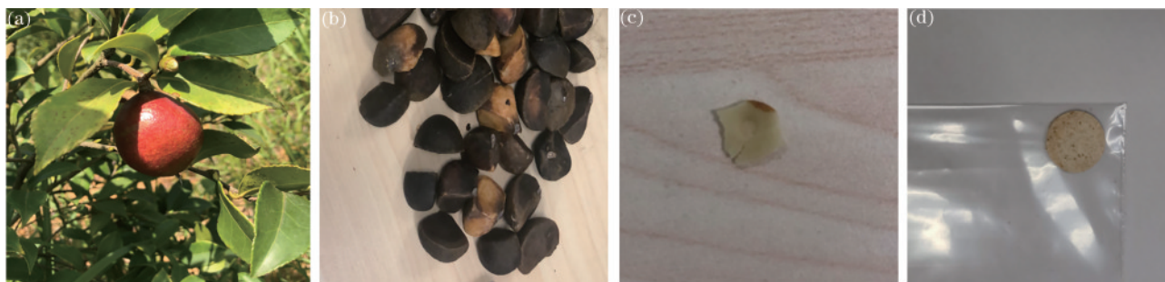
图 1 油茶果和油茶籽样品图。(a)成熟的油茶果;(b)油茶果去除壳后的油茶籽;(c)用于中红外光谱测试的油茶籽切片样品;(d)用于远红外光谱测试的油茶籽与聚乙烯粉末混合研磨后的压片样品
