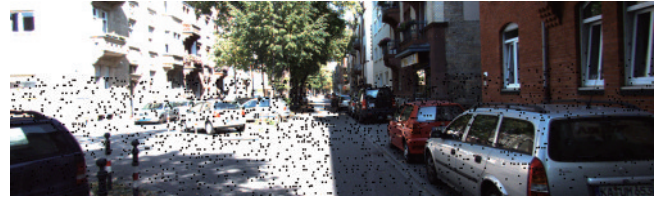
图7 稀疏点云投影到图像上的结果
