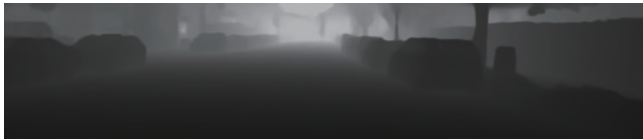
图6 深度补全网络输出的稠密深度图
