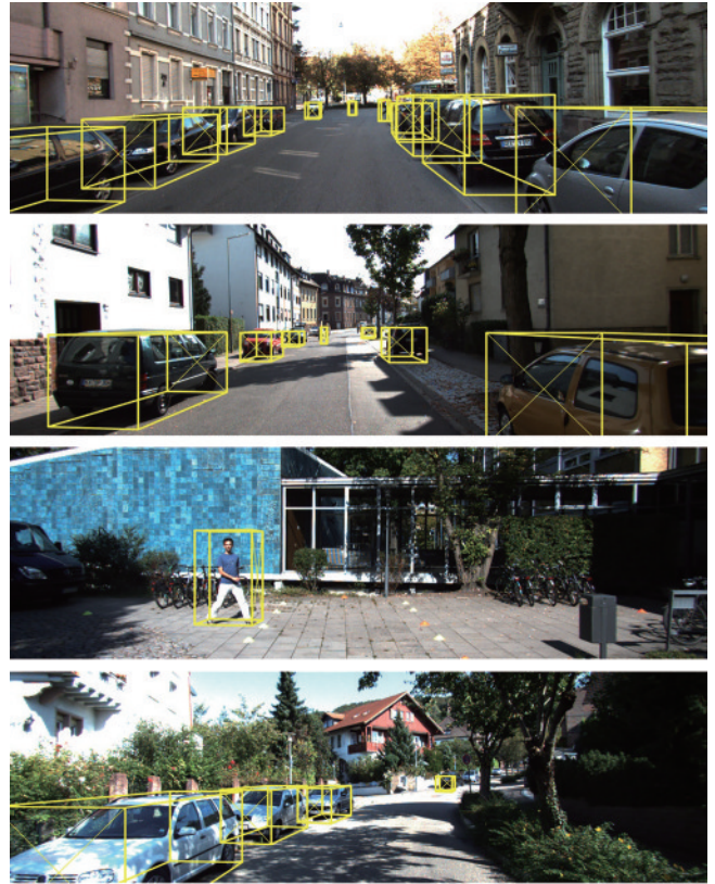
图 11 目标检测立体边界框在相机 RGB 图片上的显示效果 Fig. 11 Display effect of object detection stereo bounding box on camera RGB pictures
