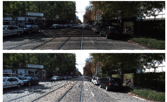
图 3 稠密点云和稀疏点云分别投影到图像上的结果
