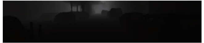
图8 深度补全网络输出的稠密深度图
