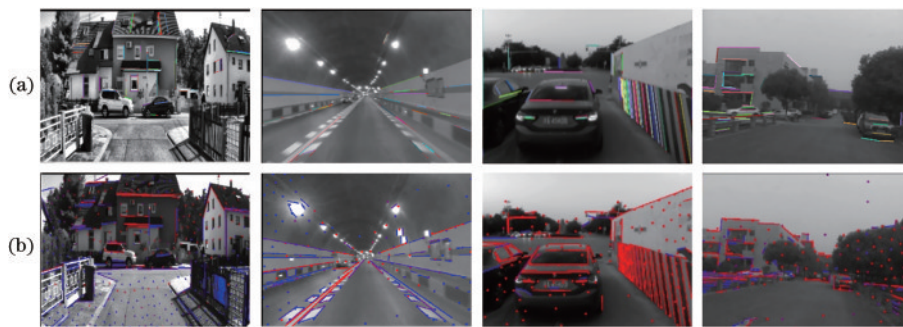
图 6 传统 LSD 算法和提出算法线特征匹配结果。(a) LSD 算法; (b) 提出算法
