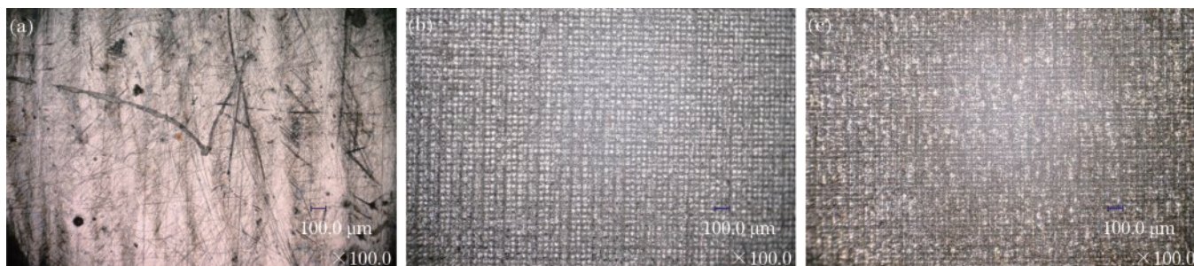
图2 试验前后金属基底表面形貌。(a)清洗前;(b)清洗后(脉冲能量为0.5 mJ);(c)清洗后(脉冲能量为1.0 mJ)
