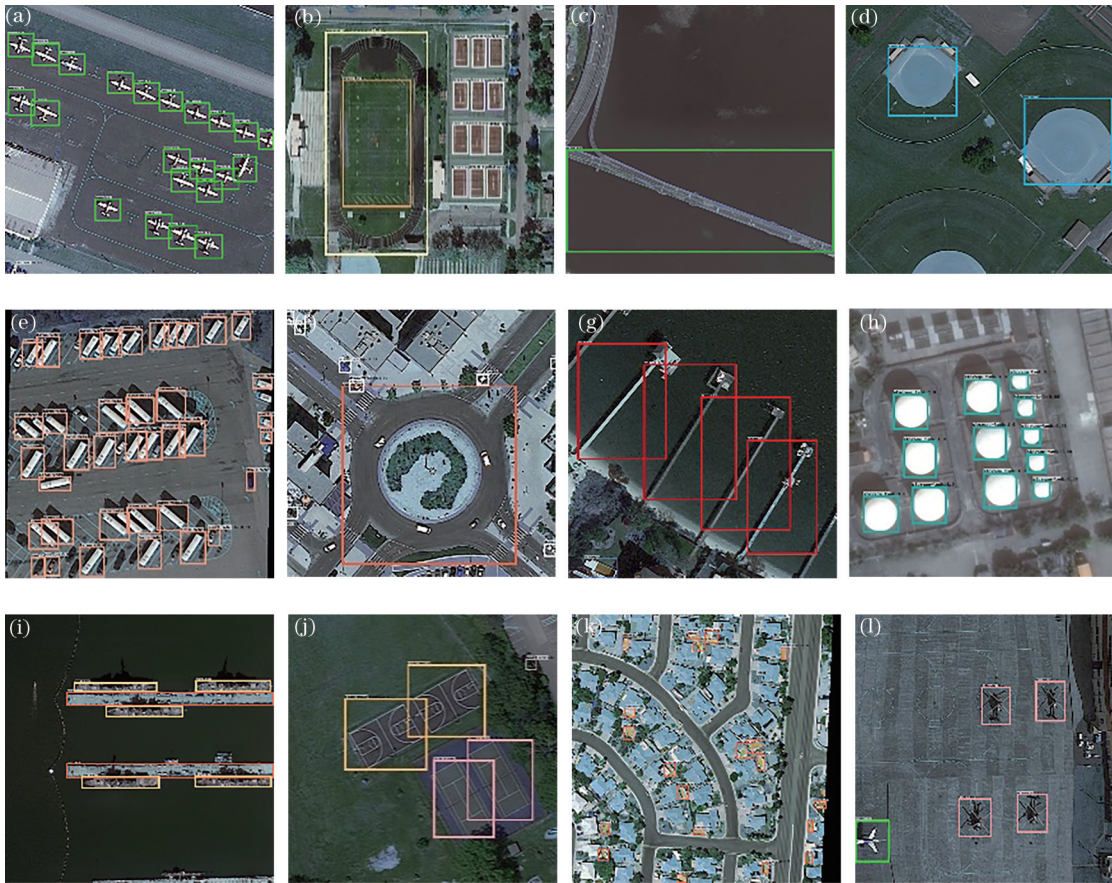
图6 DOTA数据集检测结果。(a)飞机;(b)田径场和足球场;(c)桥梁;(d)棒球场;(e)大型车辆和小型车辆;(f)环形车道;(g)港口; (h)储油罐;(i)船舶;(j)篮球场和网球场;(k)游泳池;(l)直升机 Fig. 6 Detection results on DOTA dataset. (a) PL; (b) GTF and SBF; (c) BR; (d) BD; (e) LV and SV; (f) RA; (g) HA; (h) ST; (i) SH; (j) BC and TC; (k) SP; (l) HC
