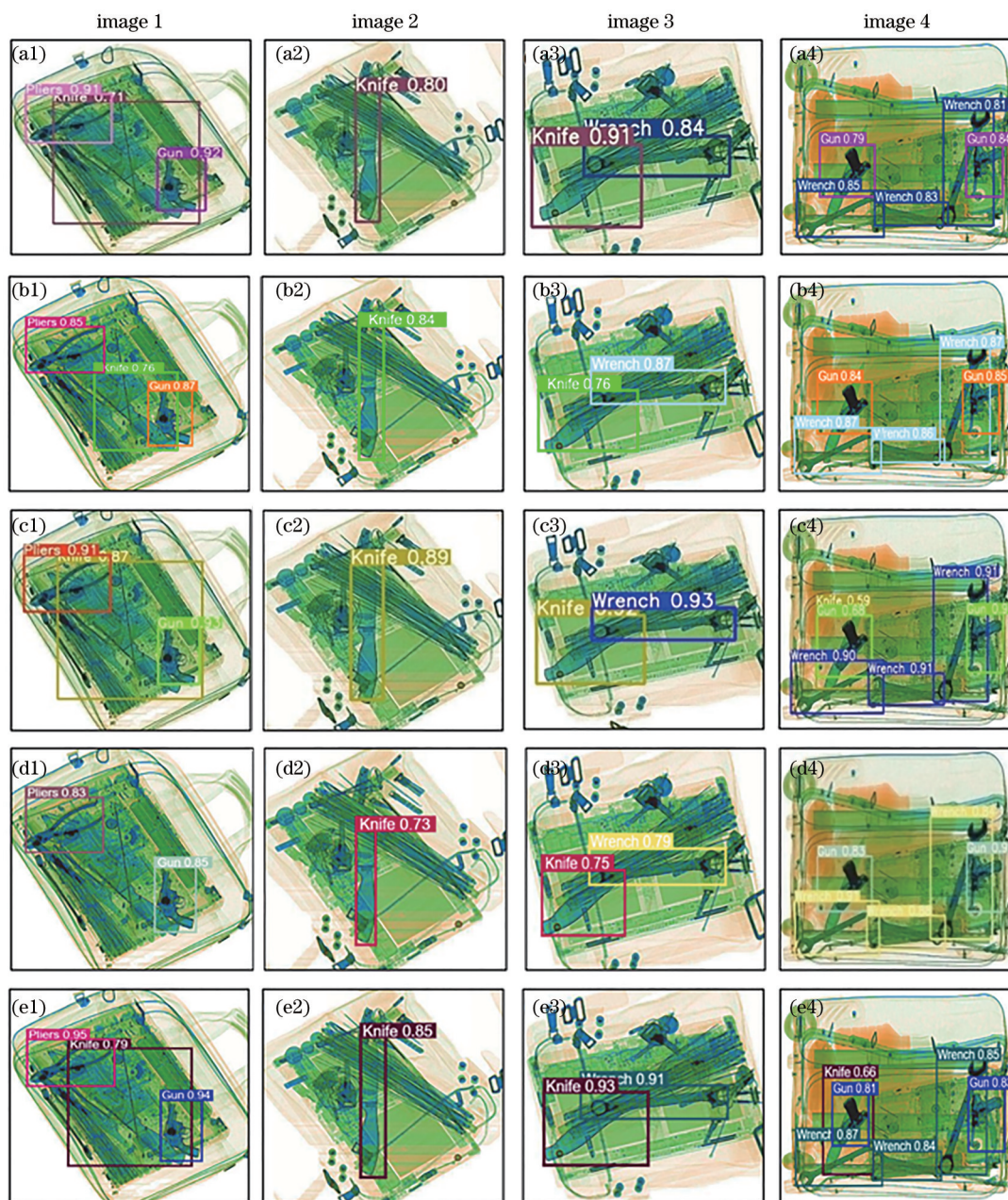
图 11 X 光图像检测结果对比。(a)YOLOv4;(b)PP-YOLOv2;(c)YOLOv5x;(d)YOLOv5s;(e)YOLOv5s-AFA
