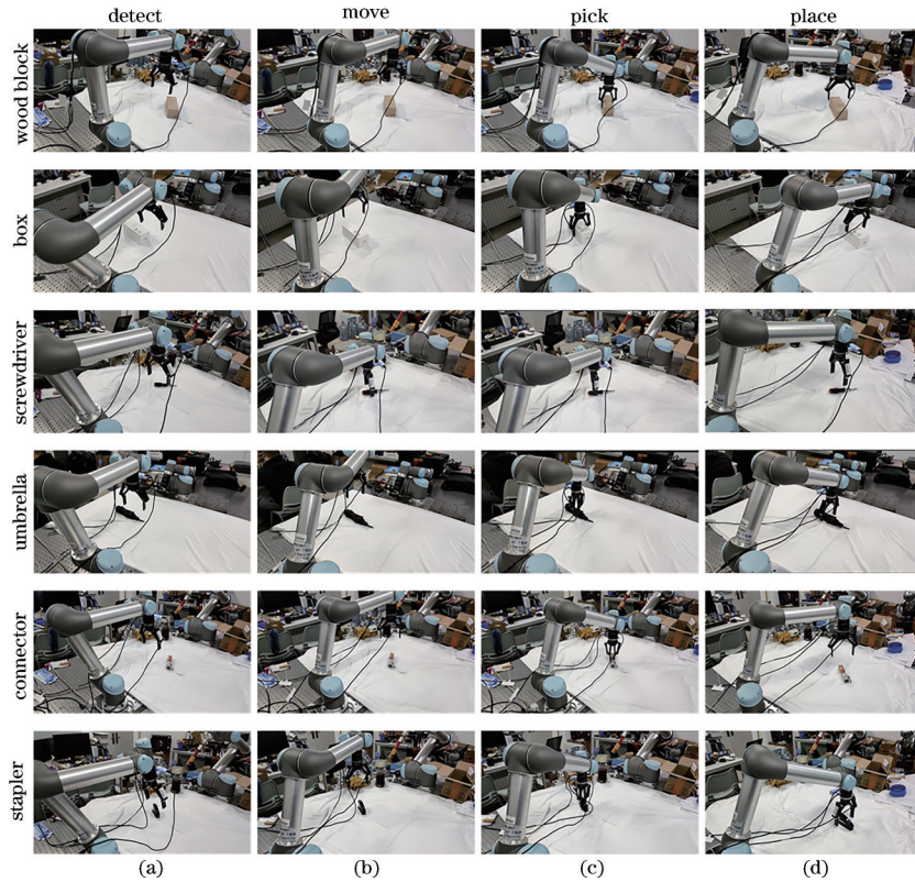
图 11 单目标抓取实验展示。(a)检测目标;(b)移动到目标;(c)抓取目标;(d)放置目标
