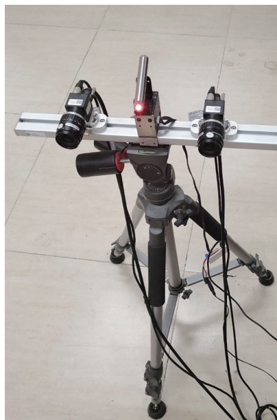
图 1 基于双目视觉与线结构光的三维重建系统
