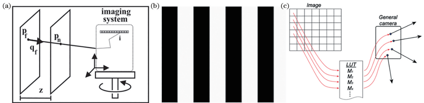
图4 双平面标定方法 [43] 。(a)双平面法标靶位姿规划;(b)二进制编码图像;(c)索引表
