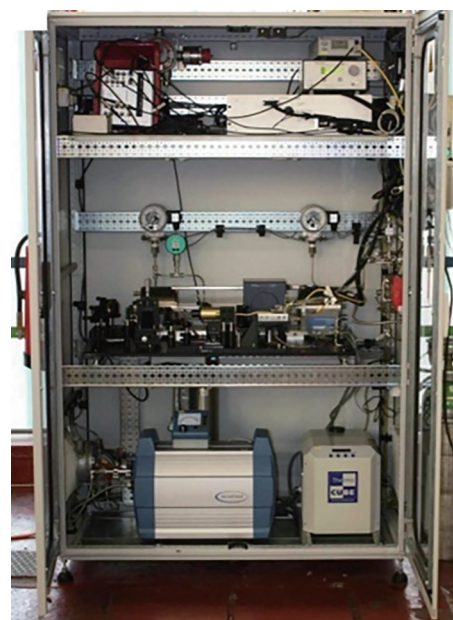
图 14 一种中红外硫化氢气体检测系统 [97]
