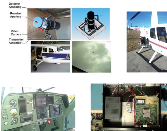
图 18 部署在 UAV 上的 RMLD [126]
