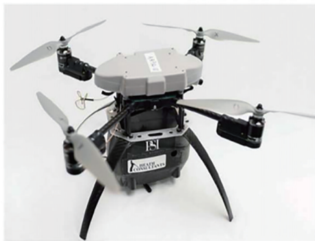
图 7 携带小型甲烷激光传感器的 UAV [45]
