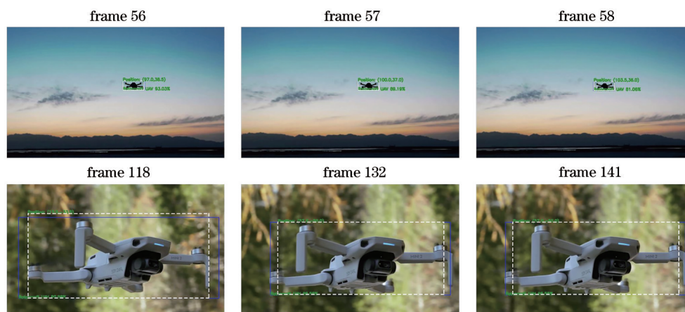
图 10 优化 YOLOv4-DeepSORT 方法跟踪效果可视化
