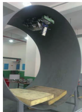
图 1 磁吸附机器人在管道内仰面工作
