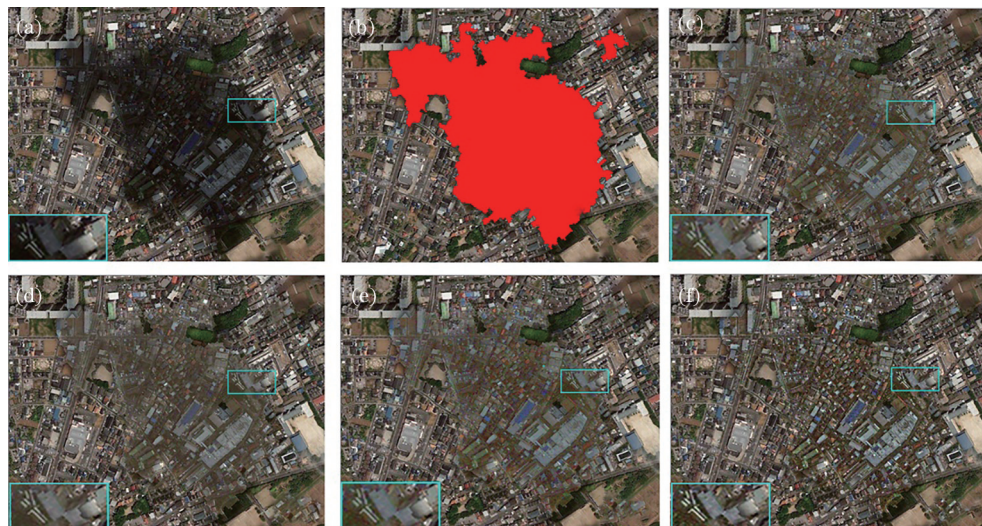
图9 影像3补偿结果对比。(a)原始影像;(b)阴影检测;(c)经典Gamma补偿;(d) Gamma修正; (e)对数变换自适应Gamma补偿;(f)所提方法
