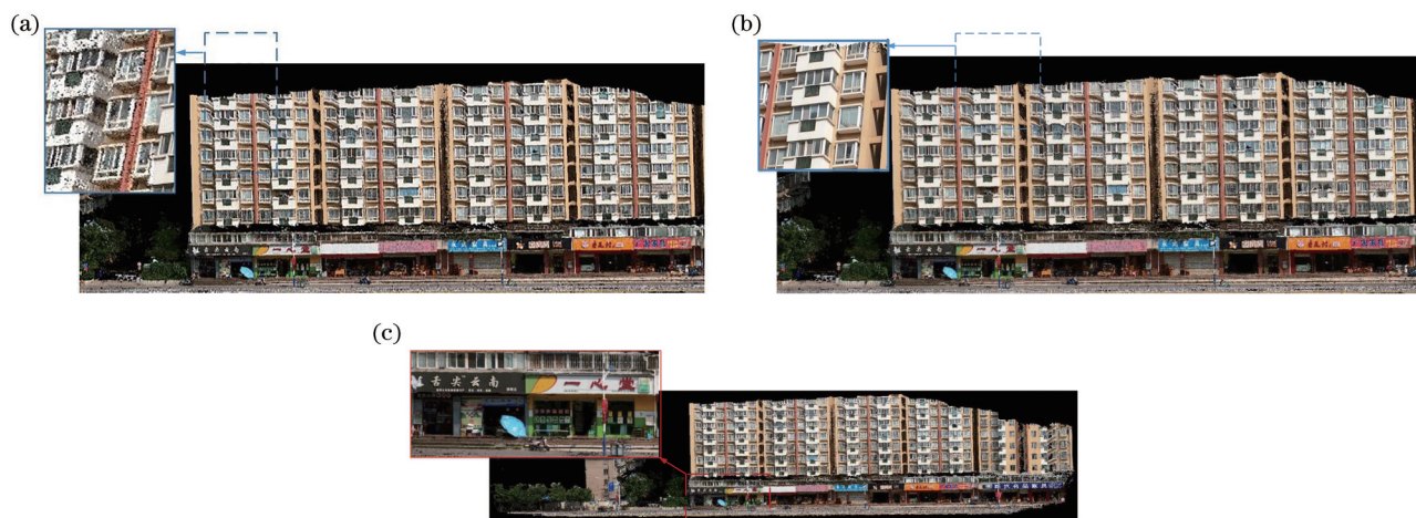
图 5 基于 Robust 估计的选权迭代法的精确配准效果。(a) 未利用 Robust 法提高配准参数精度的配准效果;(b) 利用 Robust 法提高配准参数精度的配准效果;(c) 视频影像点云与激光点云配准融合效果
