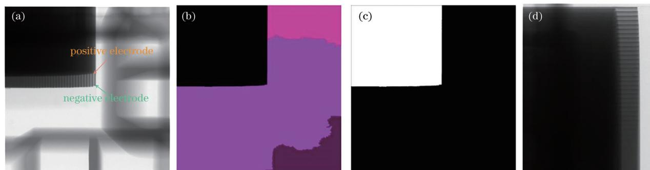
图 1 分水岭算法处理图。(a)原图;(b)连通区域标记图;(c)锂电池区域掩模图;(d)截取后的锂电池图
