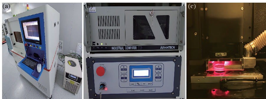
图 9 实验装置。(a)紫外激光加工设备;(b)紫外激光器;(c)加工平台
