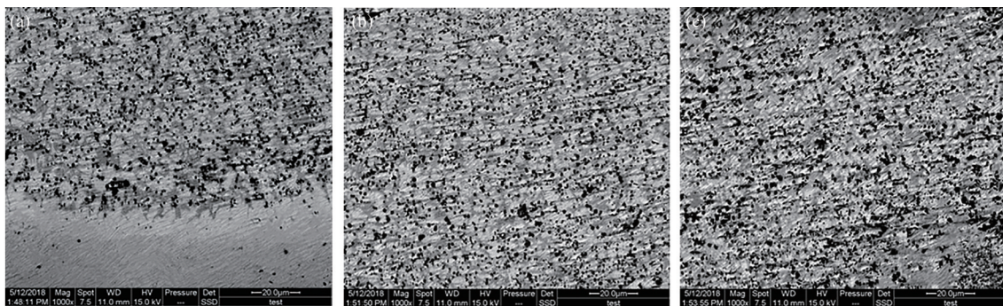
图 6 Ti-C-Nb 涂层横截面 BSE 照片。(a)涂层底部;(b)涂层中部;(c)涂层上部
