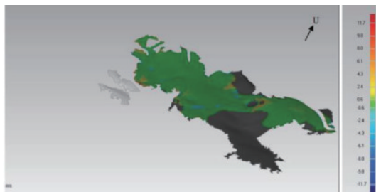
图 6 三维激光扫描技术滑坡变形监测结果 [27]
