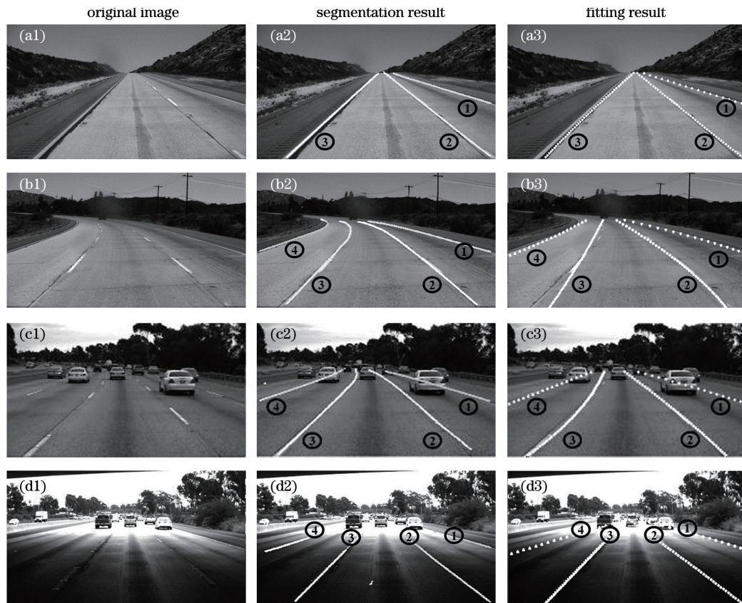
图 7 不同场景的检测结果。(a)三车道(直道);(b)四车道(弯道);(c)车辆遮挡环境;(d)光影遮挡环境
