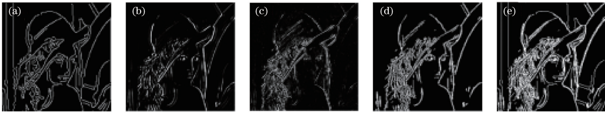
图 5 Lena 图像的边缘检测结果。(a)低频;(b)高频尺度 1;(c)高频尺度 2;(d)高频;(e)融合结果
