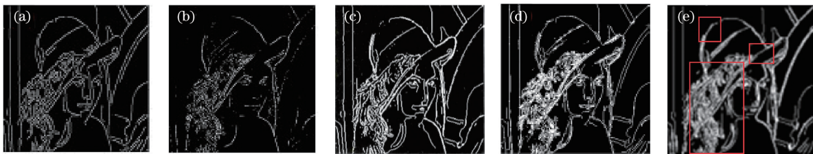
图 10 各方法对 Lena 图像的提取结果。(a) Canny; (b) 文献[7]中方法; (c) 文献[15]中方法; (d) 文献[20]中方法; (e) 本文方法
