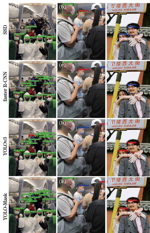
图 6 不同算法检测结果对比。(a)(b)(c) SSD 检测结果;(d)(e)(f) Faster R-CNN 检测结果;(g)(h)(i) YOLOv3 检测结果;(j)(k)(l) YOLO-Mask 算法检测结果
