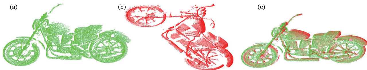
图 8 Motobike1 与 Motobike2 配准结果。(a)初始点云 1;(b)初始点云 2;(c)利用本文方法配准
