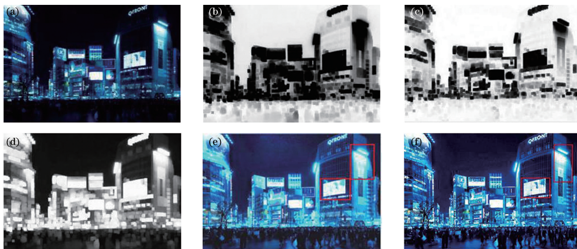
图 5 不同方法下改进透射率后的增强效果。(a)原图;(b)暗通道;(c)亮通道;(d)透射率融合图;(e)文献[19]的算法;(f)本文算法
