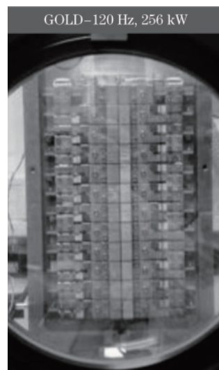
图 2 LLNL 研制 DPAL 所采用的 LD 抽运光源 Fig. 2 Pumped diode laser used in DPAL by LLNL
