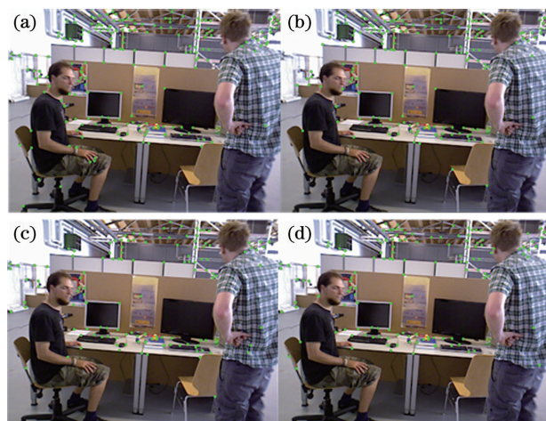
图 4 不同尺度 RANSAC 的效果对比。(a) 尺度为 1 和 0.3,内点数量为 238;(b) 尺度为 1 和 0.2,内点数量为 210;(c) 尺度为 1 和 0.1,内点数量为 159;(d) 尺度为 0.1,内点数量为 168
