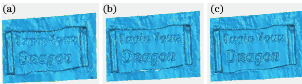
图 6 golden bucket 模型在各精简比例下的模型图。 (a) 精简比例为 0.1 时; (b) 精简比例为 0.2 时; (c) 精简比例为 0.5 时
