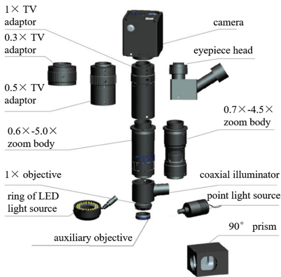
图 11 无限远单筒连续变倍数码显微镜系统
