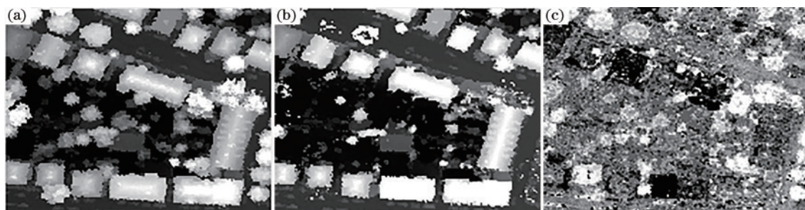
图1 机载LiDAR数据源特征图像。(a)首次回波高程;(b)末次回波高程;(c)回波强度
