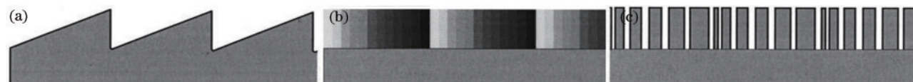
图 12 二元闪耀光栅耦合器的设计原理 [35] 。(a)闪耀光栅;(b)等价形式的渐变折射率光栅;(c)二元闪耀光栅
