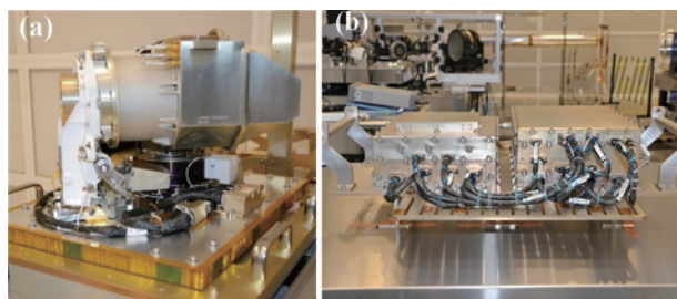
图 7 LCT 实物图 [13] 。(a)光学模块;(b)调制解调器
