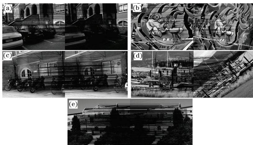
图 4 图像匹配结果。(a)亮度变换;(b)视角变换;(c)模糊变换;(d)旋转和放缩变换;(e)压缩变换
