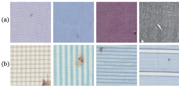
图 2 粗糙度测量分类结果。(a) 简单纹理织物图像; (b) 复杂纹理织物图像
