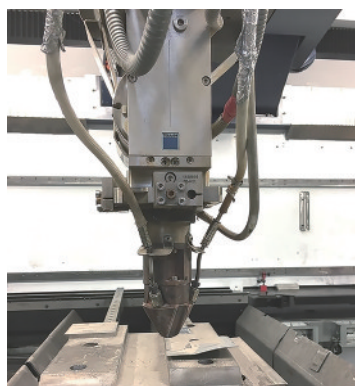
图2 TruDisk4002型同轴送粉光纤激光器
