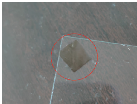
图 3 制作的 GO 薄膜
