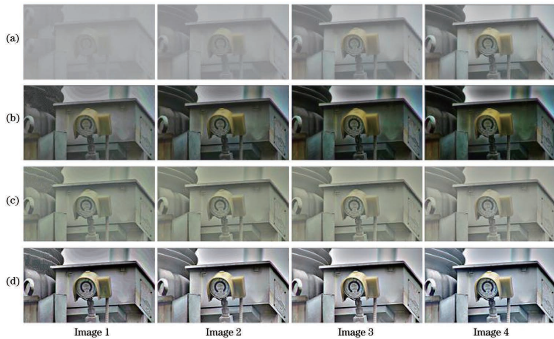
图 6 图像去雾对比图。(a)加雾图像;(b)暗通道去雾图像;(c)MSRCR 去雾图像;(d)本文去雾图像
