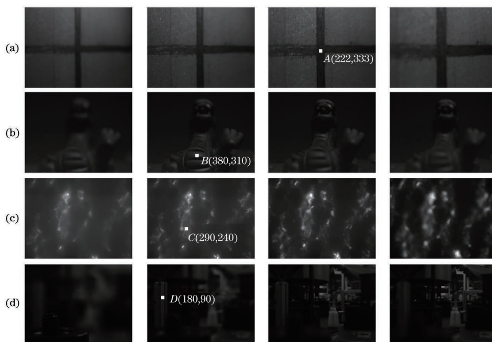
图 8 部分离焦图像。(a)使用成像镜头,通过目标扫描的方式采集的离焦图像;(b)使用成像镜头,通过探测器扫描的方式采集的离焦图像;(c)使用显微镜头,通过探测器扫描的方式采集的离焦图像;(d)通过变焦方式采集的离焦图像
