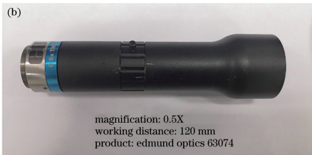
图 3 试样与镜头。(a) 不锈钢拉伸试样; (b) 0.5X 远心镜头
